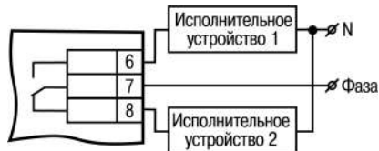
Рисунок 5.7 – Схема подключения нагрузки к ВУ типа «Р»
