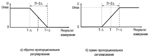
Рисунок 7.9 – Принцип формирования выходного сигнала П-регулятора для приборов с ВУ типа У
