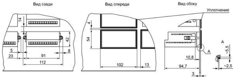
Рисунок 4.5 – Прибор в корпусе Щ2, установленный в щит толщиной 3 мм
